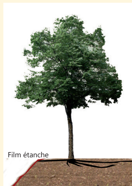
Pose d'un film étanche pour éviter le dessèchement de la terre autour des racines lors de fouilles de plus de 15 jours
