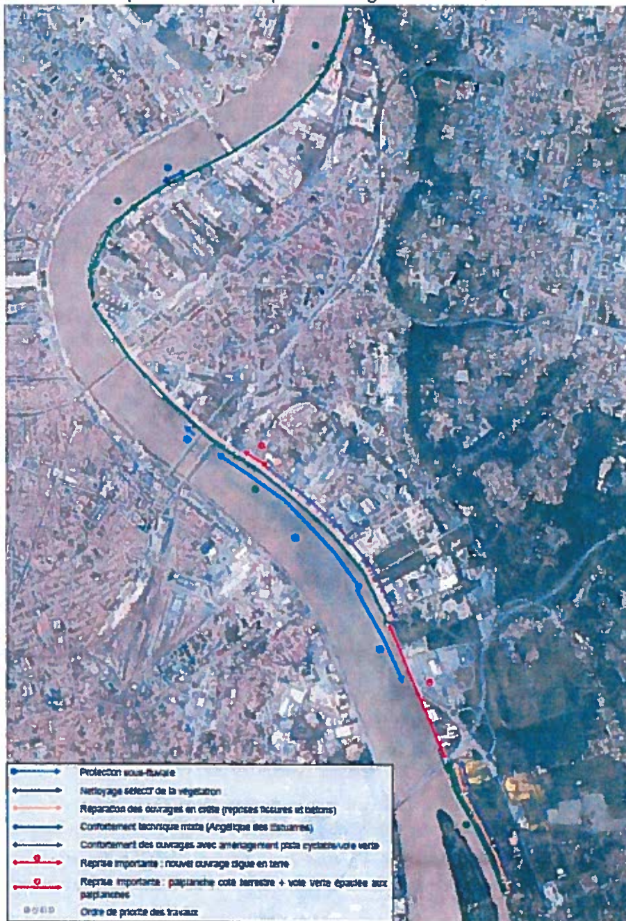
Synthèse des localisations des opérations de confortement, extrait du dossier de demande d'autorisation.
