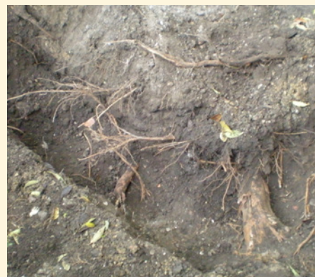
Racines endommagées par une tranchée
